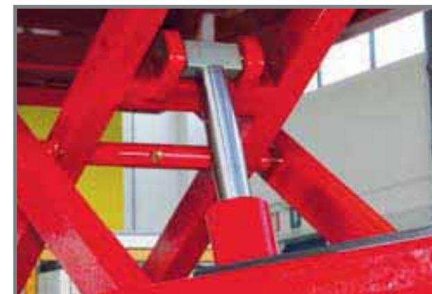
Sollevatore ausiliario libera ruote Lift Table, con pistone idraulico di sollevamento completo di valvole di sicurezza elettrica e a paracadute per la sicurezza in caso di rottura delle tubazioni. Il sollevatore ausiliario LT con portata di kg.3.500 è realizzato in conformità alla nuova EN 1493/aggiornata agosto 2010.
