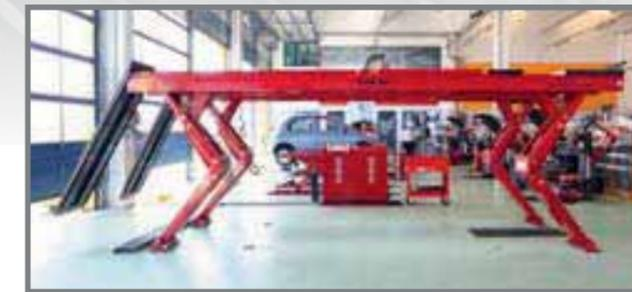
L'innovativo design del sollevatore permette una libertà a terra senza confronti. Il ponte è transitabile in tutte le direzioni in quanto non esistono ingombri a terra
