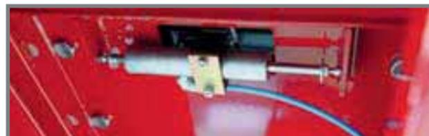
Bloccaggio pneumatico dei piatti oscillanti posteriori ( optional per Kar 45 ) a 2/3 della loro estensione per la massima compatibilità con gli assetti di nuova generazione.
