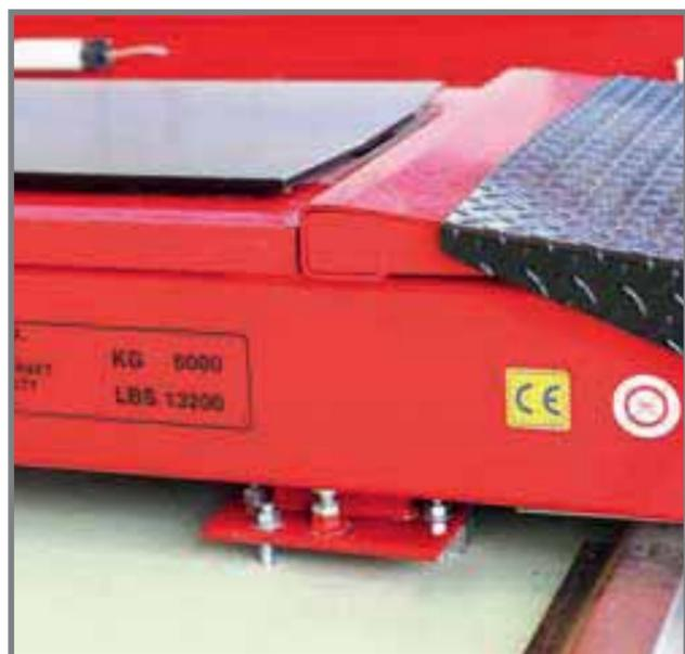
Viti di fissaggio a terra e viti di regolazione / livellamento della corsia.
