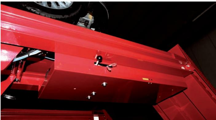
■ Scherenhebebühne elektrohydraulisch betrieben mit Tragkraft 4500 kg.
